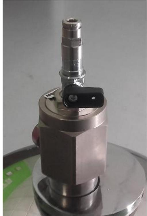
16. Coloque la tapa de la maneta de la llave. Mantenga la llave en posición OFF.
