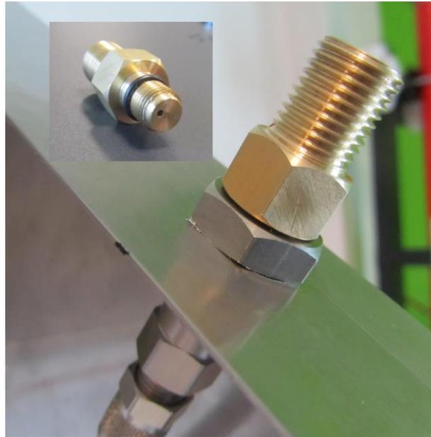
Utilice un adaptador que se adapte en la entrada de presurización y presione el obús, para permitir la entrada del gas. Referencia Aguilera Mod.: AEX/SFADP (no suministrado)
